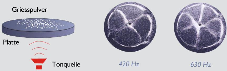
Griesspulver wird durch einen Ton in Schwingung versetzt.
